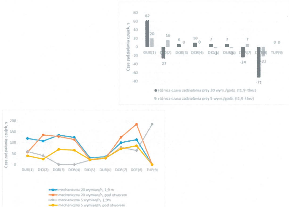
Rys. 10. Porównanie czasów zadziałania czujek w zależności od wentylacji z krotnością 5 i 20 wym./godz. przy umiejscowieniu pożaru pod instalacją wentylacyjną i w odległości 1,9 m od miejsca zasysania powietrza, a. b – różne układy przedstawienia wyników pomiarów (oznaczenie: t1,9 – czas zadziałania czujek przy oddaleniu pożaru od otworu o 1,9 m, tbez – czas zadziałania czujek dla pożaru bezpośrednio pod otworem wentylacyjnym)
