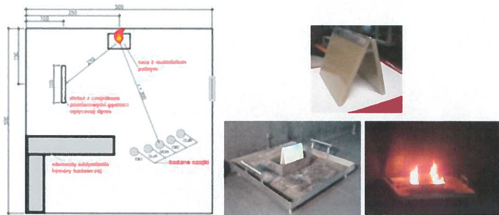
Rys.19. Schemat układu pomiarowego zastosowanego podczas badania spalania tworzyw sztucznych polimerowych wraz ze źródłem testowym (układ połączeń płyt, sposób ustawienia na tacy i wygląd spalania)
