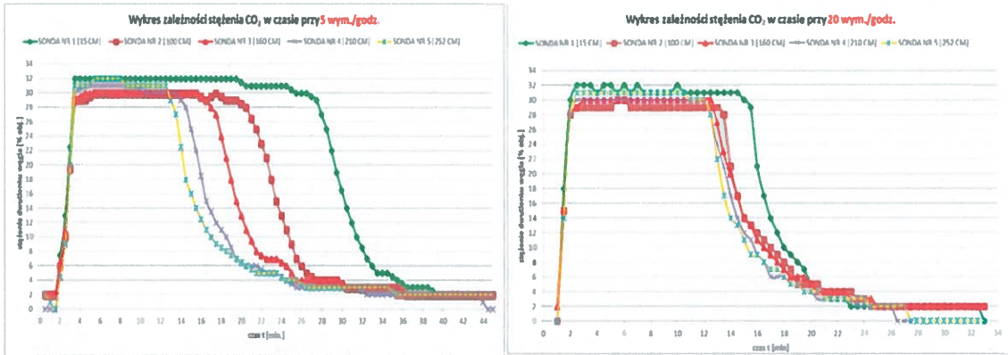
Rys. 35. Wykresy zmian CO 2 w czasie wyładowania przy włączeniu po określonym czasie wentylacji z intensywnością 5 i 20 wymian/godzinę
