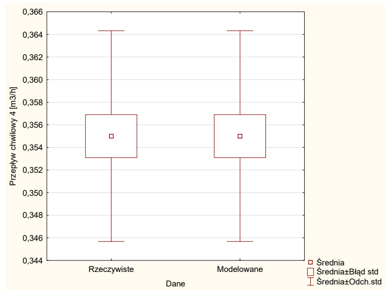
Rys.58. Błędy średniej oraz odchylenia standardowego pomiarów w trakcie pracy obiegu pierwszego dla przepływu wody obiegu 4. Opracowanie własne
