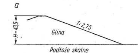
Rys. 5.5 Wyniki analizy stateczności zbrocza zapory ziemnej z uwzględnieniem ciśnienia porowego (wg Bishopa [7]) a — schemat zapory, b — porównanie wartości F określonych metodą szwedzką i metodą Bishopa
