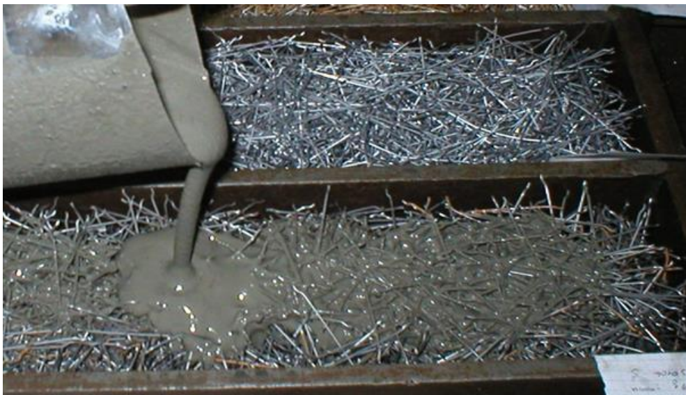
Rys.7. Wykonywanie próbek kompozytu SIFCON
